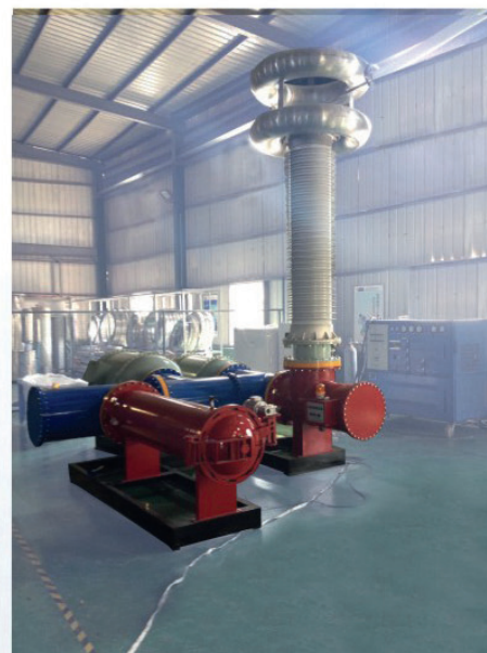
Резонансная высоковольтная установка для испытания изоляции КРУЭ стационарная
