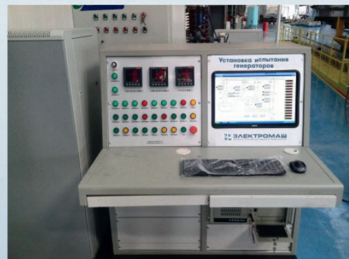
Резонансная установка для испытания изоляции турбогенераторов и гидрогенераторов
