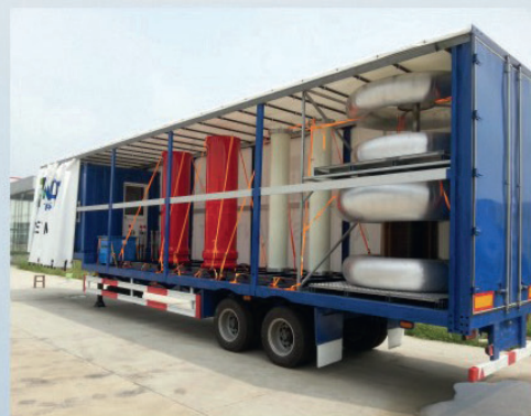
Резонансная установка для испытания изоляции КРУЭ, кабелей с изоляцией из экструдированного полиэтилена в "полевых условиях"
